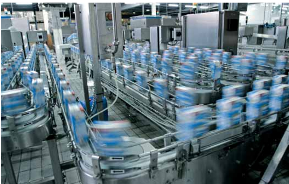
Milchsäure ist recht aggressiv und erfordert korrosionsbeständige Werkstoffe wie zum Beispiel nichtrostenden Stahl.
